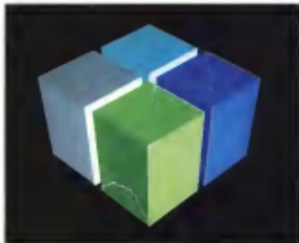
Figure 5, 6 - Proiezione Assonometrica Proiezione Prospettiva. Per proiettare su un piano su un foglio bidimensionale un oggetto a tre dimensioni esistono due metodi: quello assonometrico (le linee parallele rimangono tali) usato da Autocad e quello prospettico (le linee parallele convergono verso uno o più punti di fuga) usato da Autoshade. Nelle due figure il possibile, anche visivamente, cogliere le differenze.
